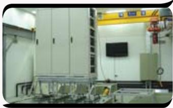
장치랙 면진 시스템 내진검증 시험 장면
